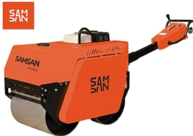
Ручной двухвальцовый дорожный каток Samsan RVR 203 предназначен для уплотнения зернистого грунта и асфальтобетона при ремонте небольших участков дорог, обочин, тротуаров. Идеально подходит для работ во дворах, у подъездов и гаражей - где работа с большими катками затруднена.
