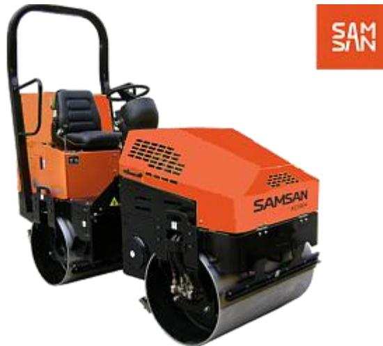
Поворотный двухвальцовый дорожный каток с сиденьем оператора Samsan RVR 225 предназначен для уплотнения промежуточных и финишных слоев асфальтобетонных покрытий при ремонте и строительстве автомобильных, велосипедных и пешеходных дорог тротуаров, обочин, парковок и других площадок
