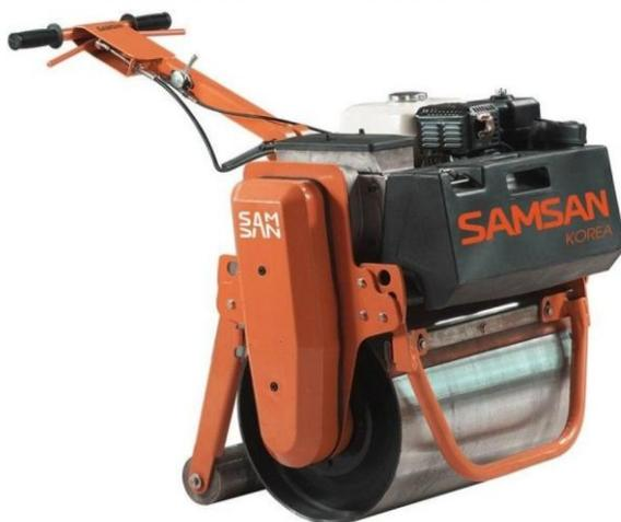
Дорожный каток ручной одновальцовый Samsan SDR 260 предназначен для уплотнения различных дорожных покрытий, начиная от зернистых материалов (таких как грунт), заканчивая асфальтобетонными смесями, где применение обычных катков невозможно из-за их размеров и ограниченной маневренности.
