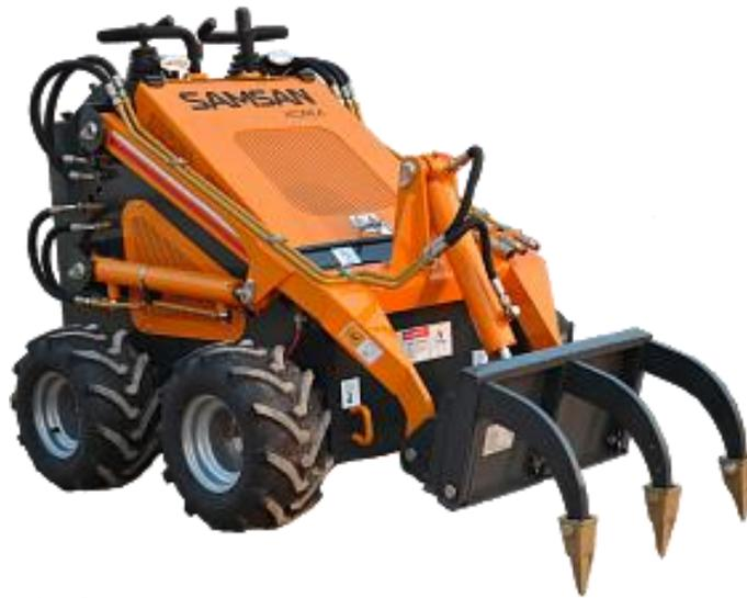
Мини-погрузчик Samsan UL-30 используется в дорожно-строительной сфере, на предприятиях, складах и сельском хозяйстве. Эту машину можно использовать в качестве бульдозера, буровой машины, экскаватора, снегоуборщика или бетономешалки. Более того, при помощи данного мини-погрузчика Samsan UL-30 появляется возможность транспортировки грузов в захватах или в ковше, буксировать какое-либо оборудование или прицепы.
